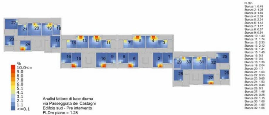
Figura 5: Analisi del FLD per l'edificio sud piano 3
